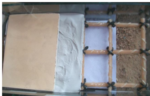
Рис. 3 – Изготовление макета с применением композитной арматуры
